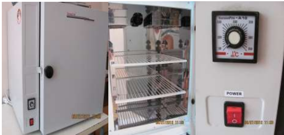
Рис. 2.7 – Шкаф сушильний лабораторний TermoLab для прогріву пилку
